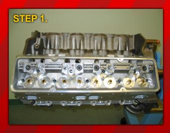
THE STAND HEIGHT CAN BE CHECKED WITH THE HEAD EITHER ON A BLOCK OR WITH THE HEAD SITTING ON A BENCH.
